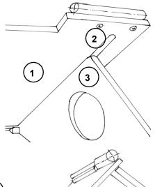
3. Durch die vorgebohrten Löcher (4) das Dach fest mit den Schrauben 3x25mm anschrauben.
