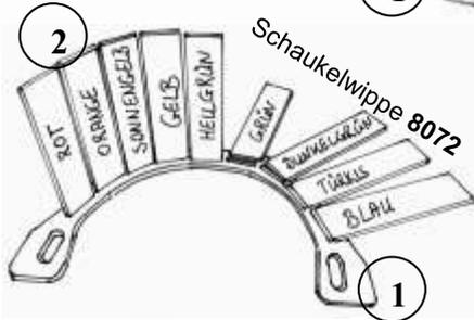
3. Stecken Sie die mitgelieferten Schrauben 4 x 40mm (4) in die vorgebohrten Löcher des Seitenteils (3) und ziehen diese fest an. Anschließend drehen Sie die Baby- bzw. Schaukelwippe vorsichtig um und verschrauben das andere, zweite Seitenteil (1).
