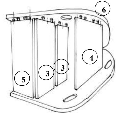
3. Nun stecken Sie die mitgelieferten Schrauben 4 x 40mm (7) in die dafür vorgesehenen Bohrlöcher des oberen Seitenteils (6) und verschrauben diese fest. Danach drehen Sie die Schiffschaukel vorsichtig um, und verschrauben das andere Seitenteil (1).
