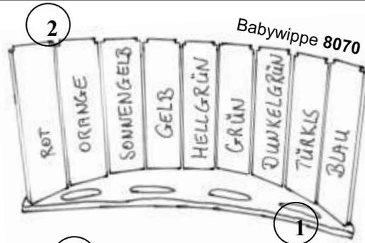
2. Richten Sie alle Querstreben (2) gerade aus und stecken Sie das zweite Seitenteil (3) oben auf. Schlagen Sie mit einem Hammer und zur Schonung des Holzes mit einem Holzklötzchen, das zweite Seitenteil fest. Alle Querstreben sitzen nun fest in den Seitenteilen.
