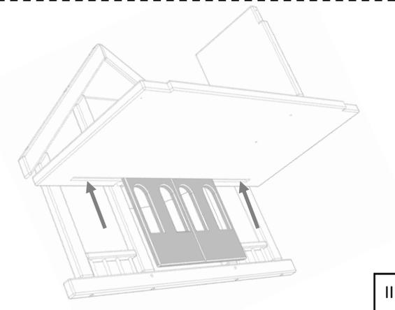
Bodenplatte mit Vorderteil verschrauben | Raumteiler verschrauben
