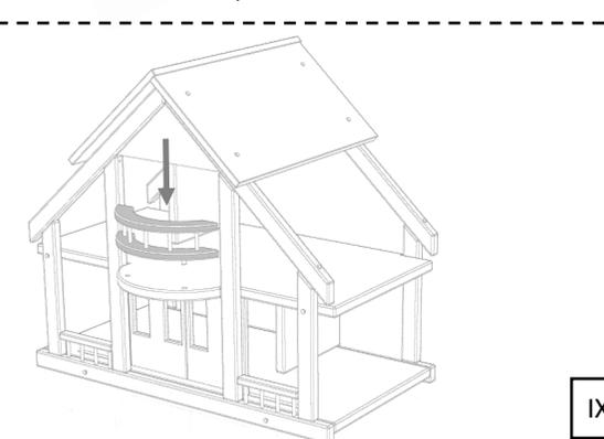
Geländer mit eingebauten Dübeln an Etagenplatte einstecken
